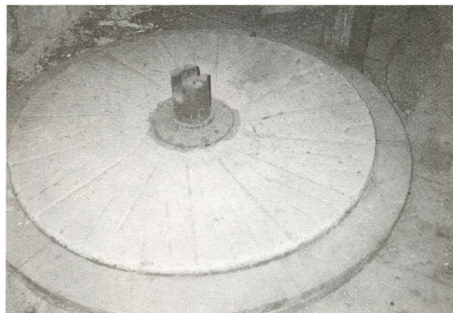
8 - Meule dormante couplée avec meule tournante (7) (1 er étage).
