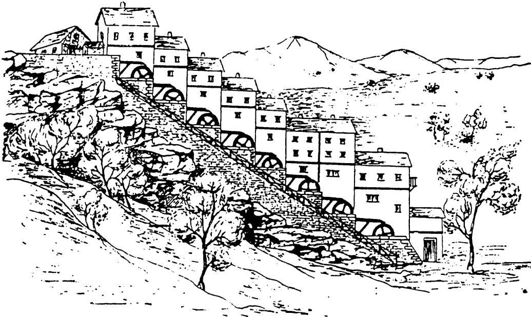
Meunerie gallo-romaine de Barbegal, près d'Arles, avec deux séries de roues hydrauliques de huit roues chacune et actionnant globalement 32 moulins avec une production de 28 tonnes de farine en 24 heures
