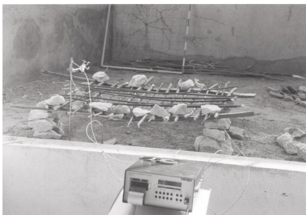
Fig. 2 - Dispositif expérimental, au premier plan centrale de mesure. On distingue les fils des capteurs.
